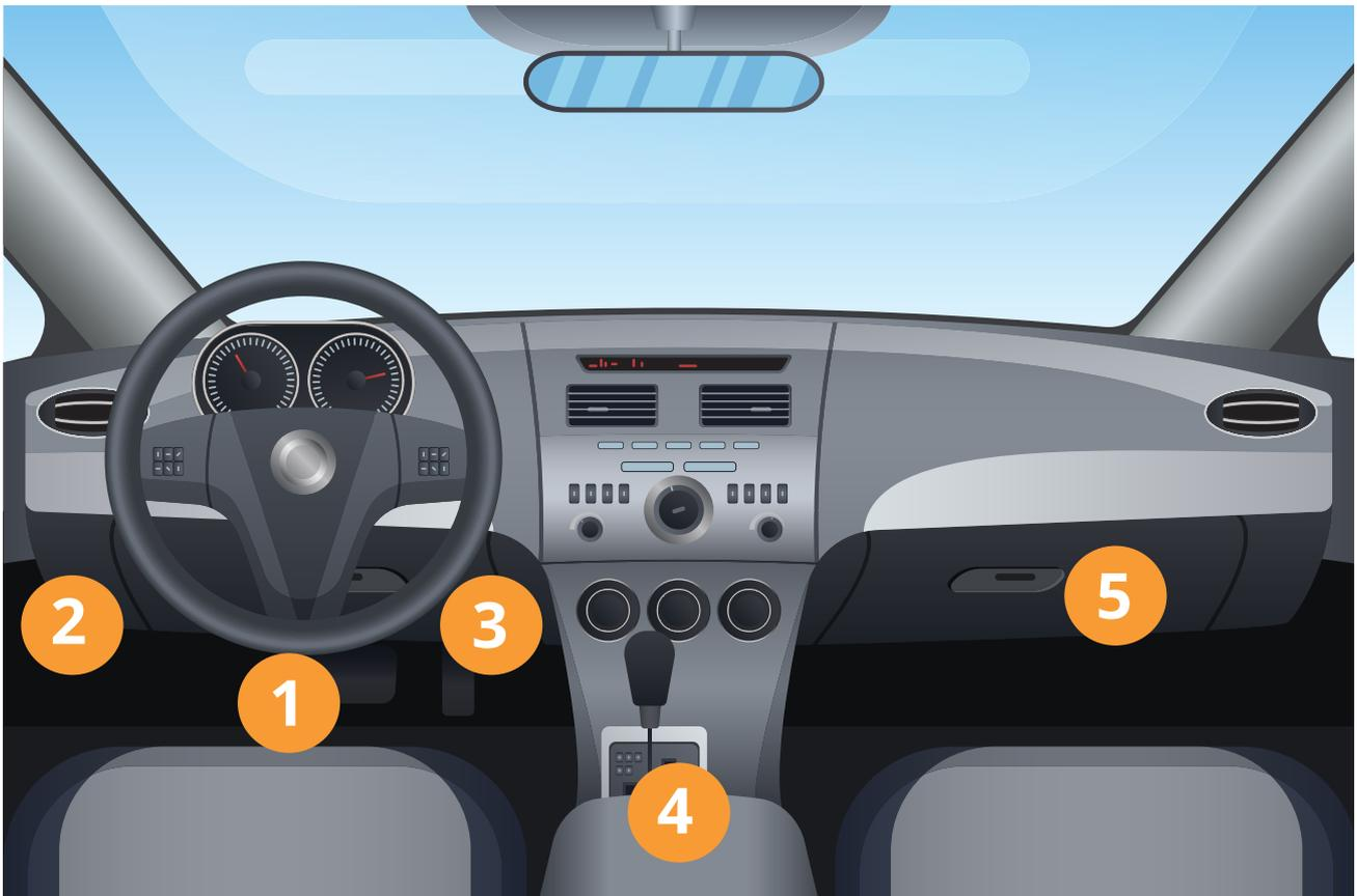
Der **OBD-Steckplatz** befindet sich bei den meisten Fahrzeugen unter dem Lenkrad im Fußraumbereich.
